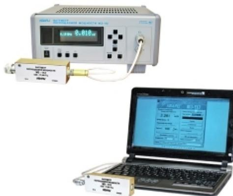
Первичный преобразователь мощности базируется на комплекте детекторов в коаксиальном исполнении в диапазоне частот 0,01–26,5 ГГц и в волноводном исполнении в диапазоне частот от 18 до 178 ГГц с разбивкой на поддиапазоны частот в соответствии со стандартными волноводными сечениями.
